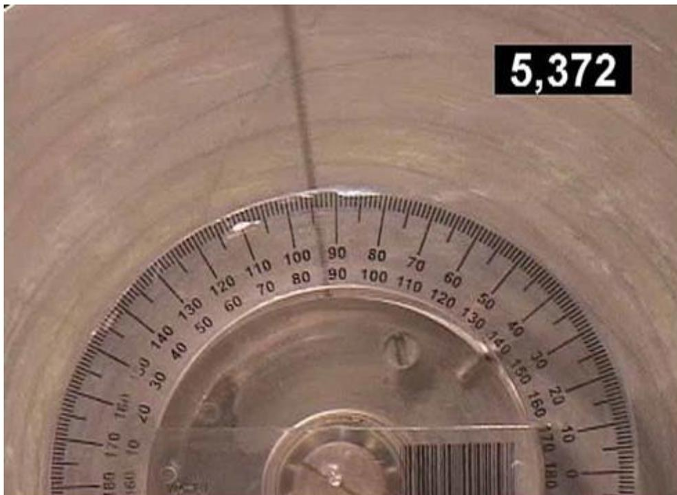
**Figura 1.** Exemplo de registro do movimento de rotação do raio-vetor de referência desenhado na roda de inércia de metal.
