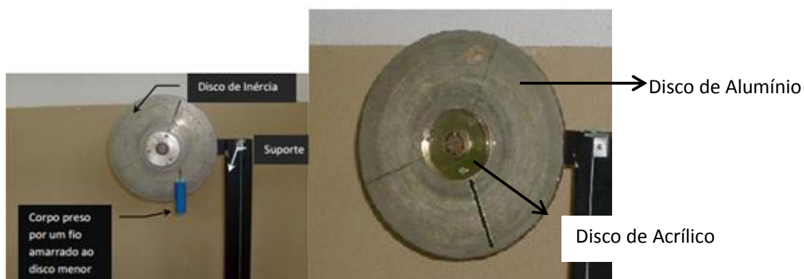
FIGURA 1: Roda de Inércia usada no experimento
