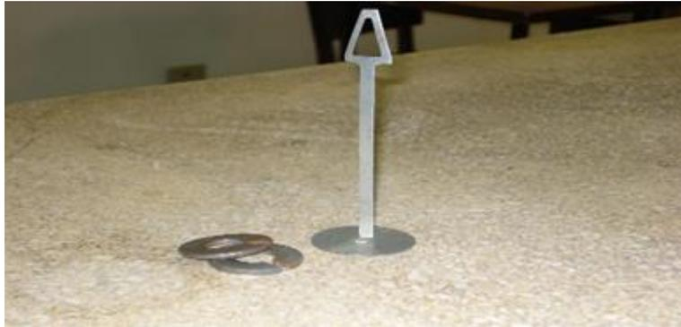
**Figura 2.** O suporte e os discos metálicos foram usados para produzir o torque na roda e fazer com que ela girasse.
