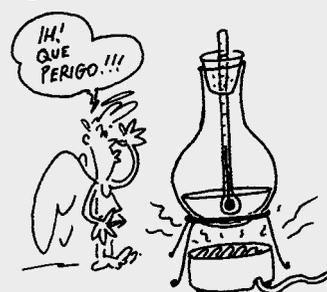
Com certeza, a pressão sobre a água teria aumentado muito, impedindo a ebulição. Seria necessário aquecer mais para provocar nova ebulição nessas condições, o que ocorreria em temperaturas maiores que a encontrada anteriormente.
