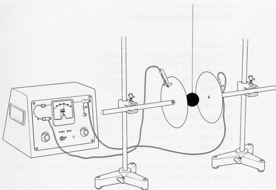
97 *Demonstration***Macro-Millikan apparatus****Apparatus**
